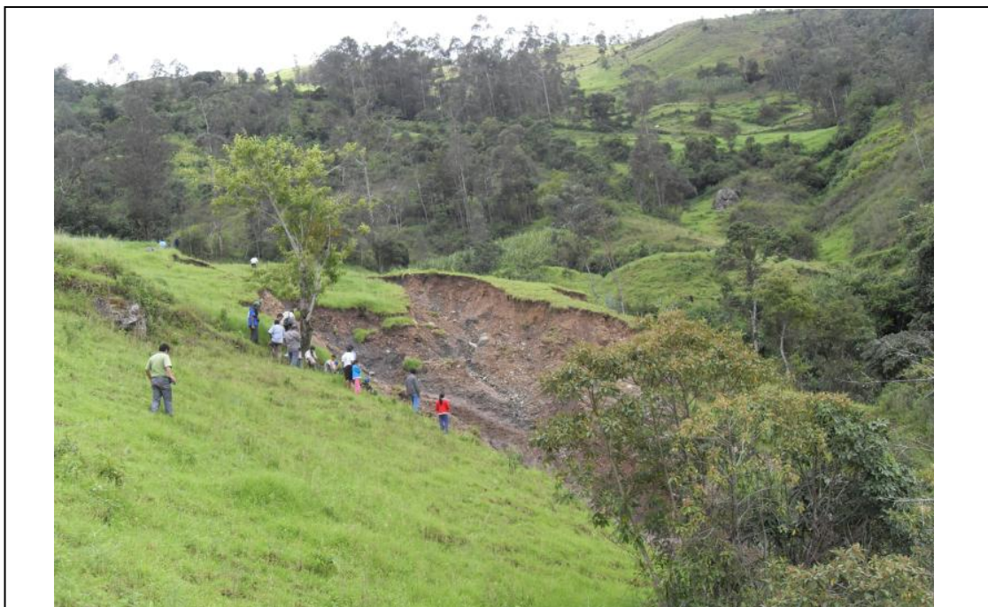
FOTO N° 10 : Vistas del escarpe principal, el cual ha cedido parcialmente debido al incremento de las lluvias de la temporada.
