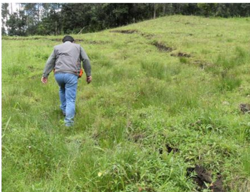
Figura 06. Agrietamientos y saltos del deslizamiento en el Caserío El Potrero
